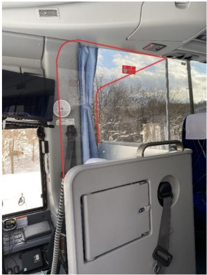
運転席と客席との間に、飛散防止のためアクリル仕切り板を設置しております。
